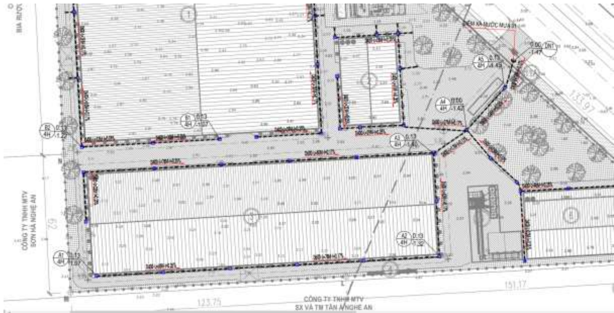
Hình 6. Hệ thống thu gom nước mưa của Nhà xưởng Phoenix
