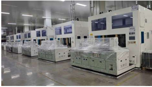
Công đoạn khử keo tự động và bán tự động của dây chuyền sản xuất tấm đĩa bán dẫn
