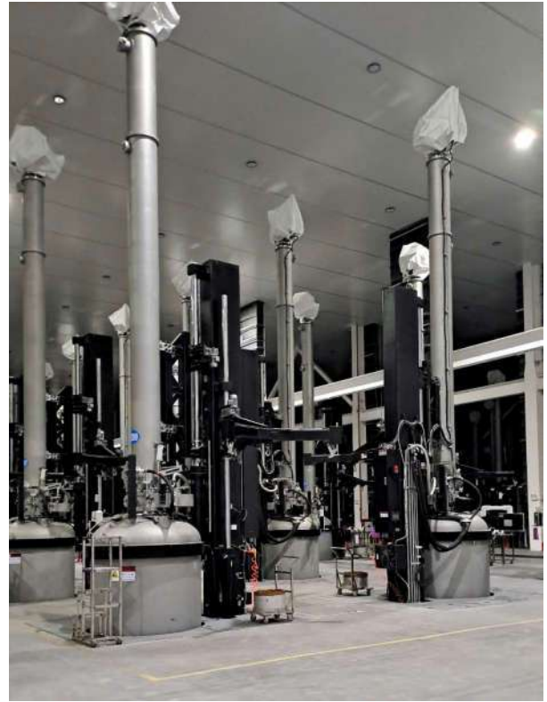
Nồi nấu thạch anh và công đoạn kéo thổi silic đơn tinh thể của dây chuyền sản xuất thanh silic đơn tinh thể
