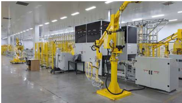
Công đoạn dán thanh của dây chuyền sản xuất tấm đĩa bán dẫn
