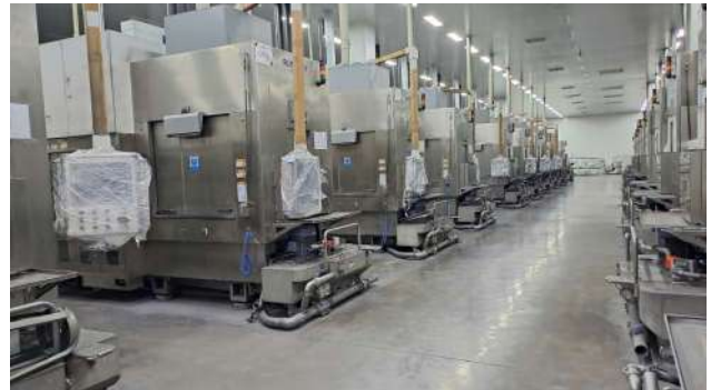
Công đoạn cắt tấm của dây chuyền sản xuất tấm đĩa bán dẫn
