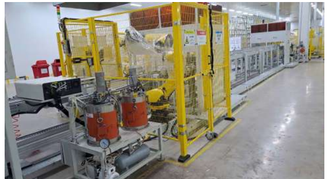
Công đoạn dán thanh của dây chuyền sản xuất tấm đĩa bán dẫn
