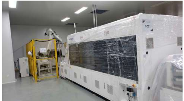
Công đoạn phân loại của dây chuyền tái sử dụng nguyên liệu silic
