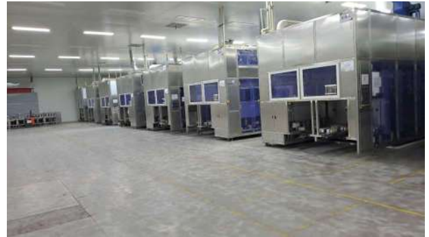
Công đoạn khử keo tự động và bán tự động của dây chuyền sản xuất tấm đĩa bán dẫn
