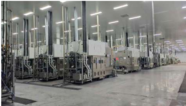
Công đoạn cắt tấm của dây chuyền sản xuất tấm đĩa bán dẫn
